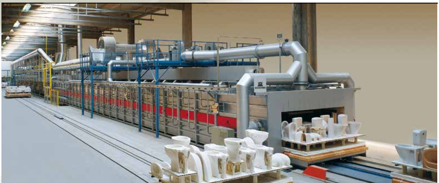
Tunnel Kiln with Car Conveyance for Firing Sanitaryware Tunnelofen mit Wagenförderung für das Brennen von Sanitärprodukten Horno túnel con circulación de vagonetas para la cocción de sanitarios
